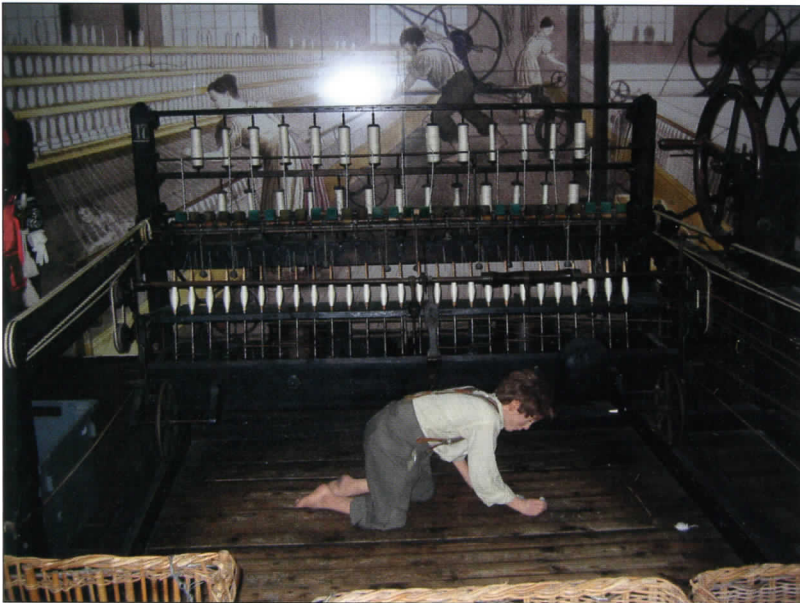
Een zogenaamde 'spinning Jenny', de fijnspinnmolen, het laatste onderdeel van een spinassortiment, in het Museum voor Industriële Archeologie en Textiel te Gent, eind 18e eeuw. (Foto Ronald Peeters, 2009)
