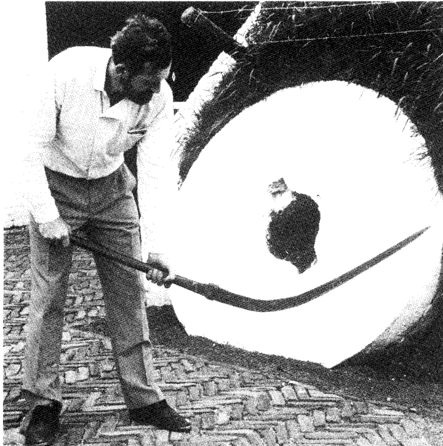
Zwèrd. Cees Prinsen demonstreert hier het zwaardvormige werktuig waarmee leem werd fijngehakt. Zie ook: fitselstèkke.
